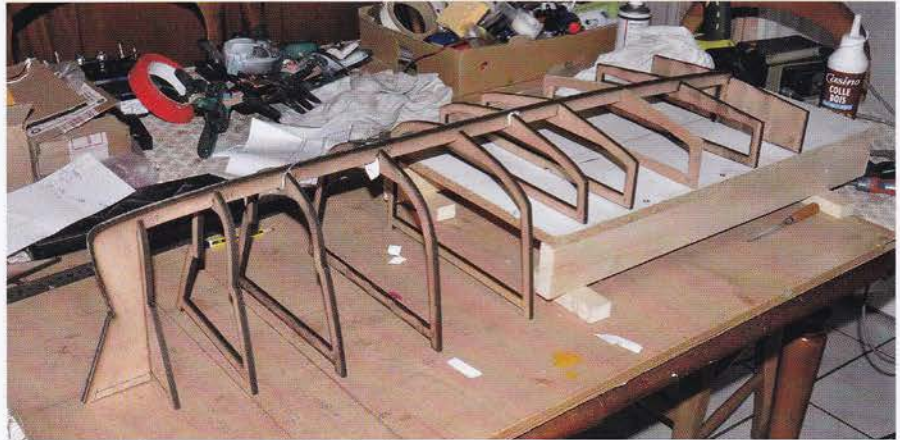
Charpente de la coque.
